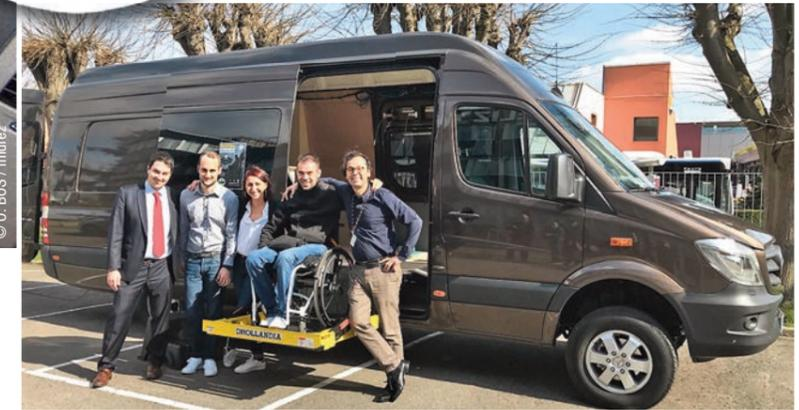
Autre transformation remarquable sur le Sprinter : l'installation d'un double plancher dans lequel prend place un haillon élévateur pour Samuel et son fauteuil, ici entouré de ses principaux partenaires.
